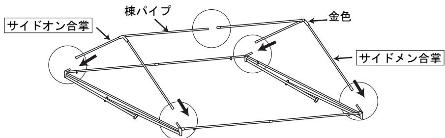
3. 天幕を枝部の前に広げ全体に被せます。 4. 枝パイプを持って片側の支柱を立て、○部の筋交いの固定をします。
