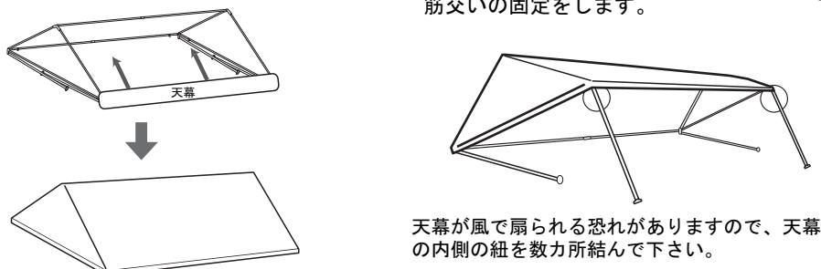
**【警告】** 筋交いは、必ず確実に取付けをして下さい。テントの強度に関わる重要な部分です。取付けを怠ると、少しの衝撃でテントが倒れ、事故の原因になる恐れがあります。
