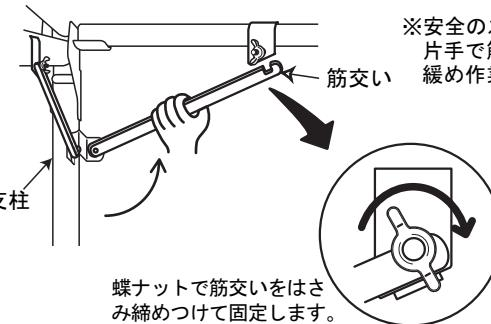
※安全の為、筋交いを取り外しの際には必ず片手で筋交いを支えながら、蝶ナットの締付け、緩め作業を行って下さい。
