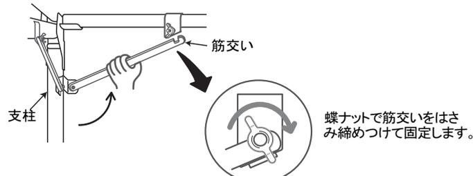
※安全の為、筋交いを取付け、取外しの際には必ず片手で筋交いを支えながら、蝶ナットの締め付け、緩め作業を行って下さい。
